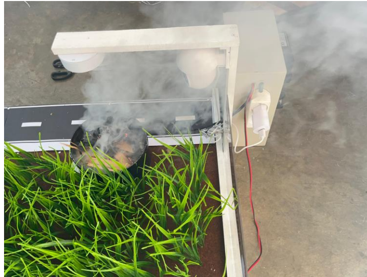
Gambar 4. 13 Pengujian Sistem Deteksi Kebakaran Menggunakan Pembakaran Daun Kering Pada Prototipe Perkebunan Tebu.
