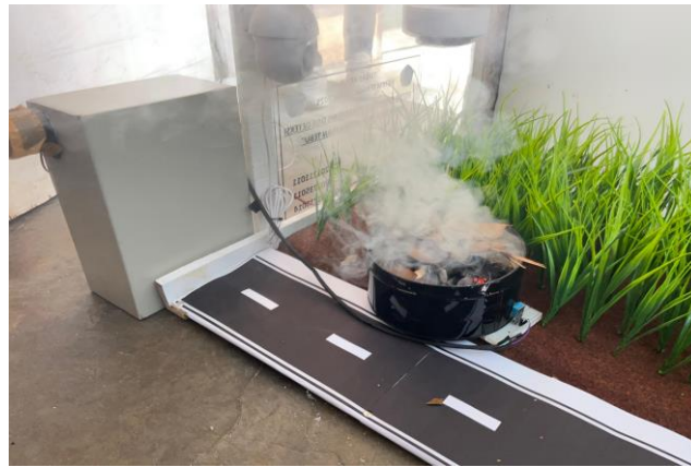
Gambar 4.10 Pengujian Sensor Suhu pada Prototipe
